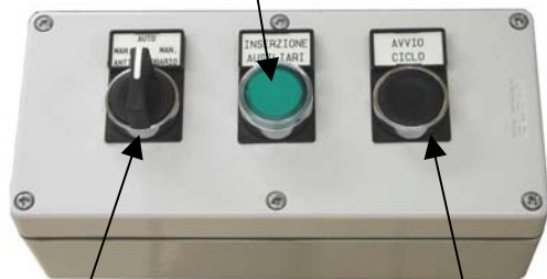
Pulsante sinistro di chiusura carter Bimanuale Safety cover closing left button
